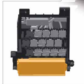
Sicherungsträger an der Vorderseite des Kunststoffgehäuses – unten
